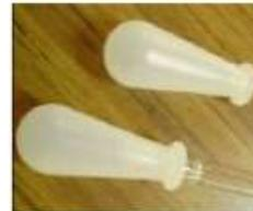
Succionador de Silicón para pipeta Pasteur de 3 ml
