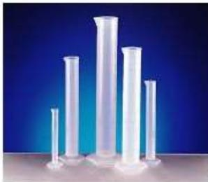
Probeta Graduada en Polipropileno
